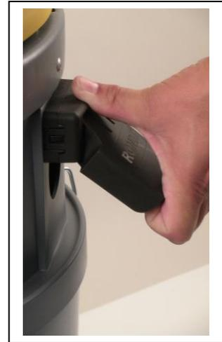
Wenn die Kraft größer als die Beeinflussung vom Vakuum ist, öffnet sich das Ventil automatisch mit einem „Puff“. Das Ventil loslassen.
