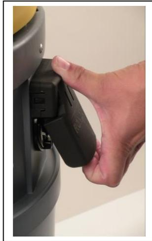
Während die Maschine abgeblendet und in Betrieb ist, zieht man mit einem gleichartigem Ruck an der Klappe des Schockventils. (Nicht am Ventil ziehen)
