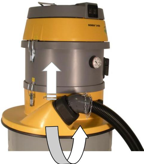
Der Luftstrom und die sehr feinen Partikel, die im Sammelbehälter nicht zu Boden fallen, werden zum Kanalfilter weiterbefördert.
