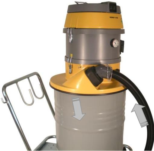
Wenn die Saugmotoren der Maschine eingeschaltet sind, wird die Luft durch die Maschine gezogen und nimmt die Staubpartikel in der Nähe der Bodendüse auf.
