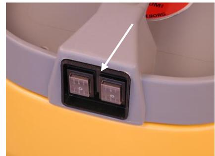
RONDA® 3400 ist mit zwei oder drei Motoren versehen, und die Saugmotoren werden an je seinem eigenen Schalter eingeschaltet, oder bei drei Motoren ein Schalter für einen Motor, und ein Schalter für zwei Motoren.
