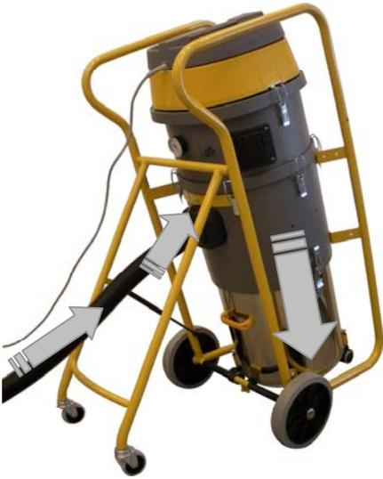
Die Luftströmung und die sehr feinen Partikel, die nicht im Sammelbehälter zu Boden fallen, werden zum Kanalfilter fortsetzen.
