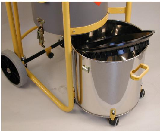
Der Sammelbehälter ist unter dem Filterbehälter, mit zwei kräftigen Behälterklammern, befestigt. Die Rollen unter dem Sammelbehälter erleichtern die Entleerung.
