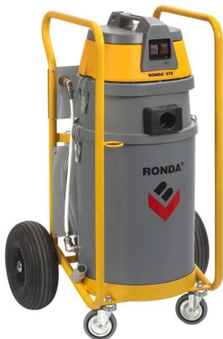
RONDA® 370 ist ein kleines, mobiles Recyclingsystem besonders für Kühlwasserversorgung von Diamantbohren, -schleifen und -sägen entwickelt. Das effektive Reinigungssystem der Maschine reinigt den Betonschlamm und sichert kontinuierliches Recycling des Kühlwassers. Gleichzeitig kann die Maschine als Nasssauger für das Saugen von Flüssigkeiten und Schlamm verwendet werden.
