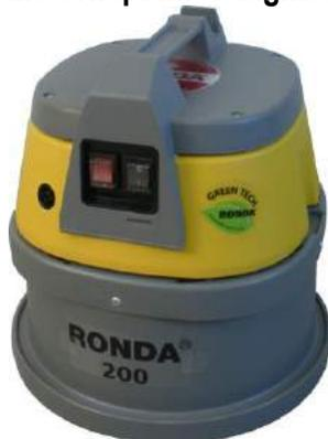
Der Motorkopf ist mit Saugmotor, einem integrierten Tragegriff, Schaltern für den Saugmotor sowie der eingebauten Ein-/Ausschaltautomatik ausgestattet.
