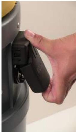
2. Während die Maschine abgeblendet und in Betrieb ist, zieht man mit einem gleichartigem Ruck an der Klappe des Schockventils. (Nicht am Ventil ziehen)
