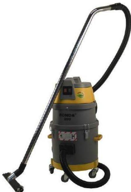
Wenn die Maschine korrekt montiert und angeschlossen ist, kann sie mit dem roten Schalter des Motorkopfes eingeschaltet werden. Die Maschine ist mit einem Alarm ausgestattet, der einen zu niedrigen Luftdurchfluss für Aufsaugen anzeigt. Dieser Alarm muss vor Gebrauch überprüft werden. Das Ansaugen am Ende des Schlauches abblenden. Die Maschine fängt an zu piepen. Die Ablendung entfernen, und der Piepser stoppt.
