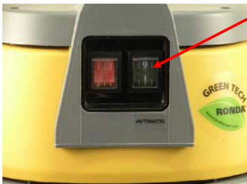
Die Ein-/und Ausschaltautomatik wird mit dem schwarzen Schalter am Motorkopf ein- und ausgeschaltet. Wenn die Ein-/und Ausschaltautomatik betätigt ist, schaltet die Maschine nicht ein, wenn man auf den roten Schalter drückt. Die Maschine wird nicht eingeschaltet, bevor das eingeschaltete Handwerkzeug eingeschaltet wird.
