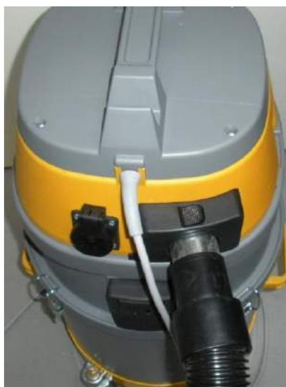
Ist die Maschine mit separatem Abblasen ausgestattet, muss man einen Schlauch für die Abblasluft verwenden.
